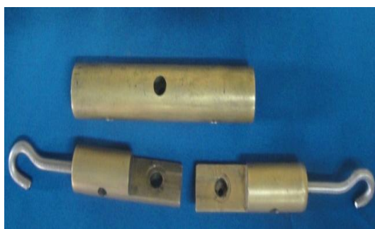
Gambar 2. Alat uji kekuatan perlekatan geser
